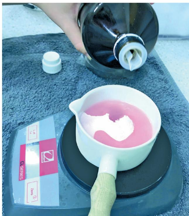
**Abb. 2a:** Das Anmischen erfolgt im vorgegebenen Verhältnis von 10:5 am besten durch Abwiegen.
