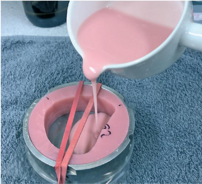
**Abb. 2b u. c:** Der Kunststoff wird in die ausgefrästen Bereiche eingefüllt und verbindet sich während der Polymerisation übergangsfrei und homogen.
