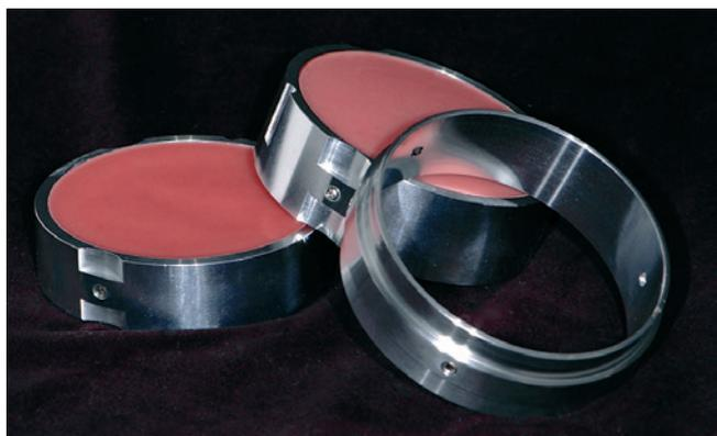
**Abb. 1:** Die Fräsrahmen werden mit dem reBlanX®-Prothesenkunststoff befüllt und auspolymerisiert. Ein 24-stündiges Wasserbad sorgt für einen Restmonomergehalt von < 1%.
