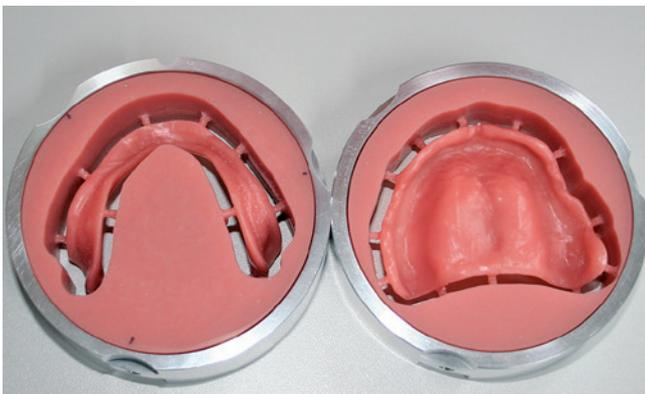
**Abb. 4:** Gefräste Prothesenbasen.
